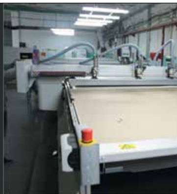
Промышленная линия цифровой резки Kongsberg XP Auto полностью автоматизирована, но и она часто не успевает за скоростью печати стоящего рядом УФ-принтера
