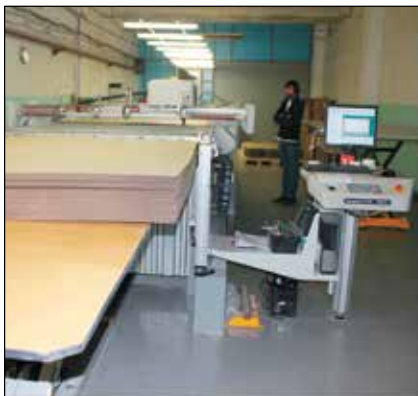
Промышленная линия цифровой резки Kongsberg XP Auto полностью автоматизирована, но и она часто не успевает за скоростью печати стоящего рядом УФ-принтера
